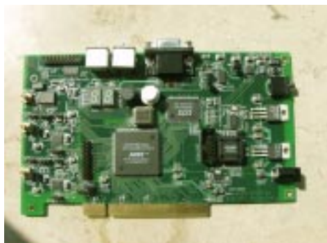
Abb. 52: ACEX-FPGA Testboard und Bildschirmausgabe von “Pac Man”
